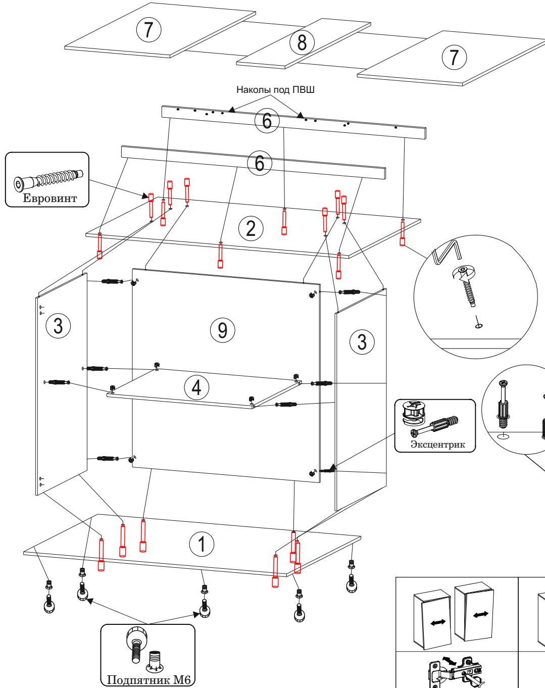
Закрепить механизм к деталям №6 и №7 на шурупы 3,5\*16
