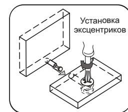
Эксцентрик вкручивается до большой шляпки
