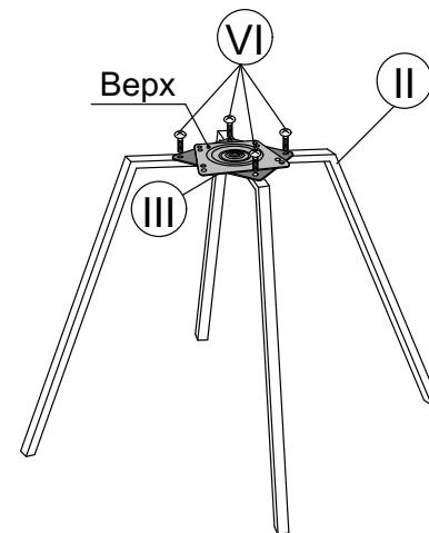
Для удобства монтажа необходимо повернуть верхнюю часть поворотного механизма относительно нижней на 45°.
