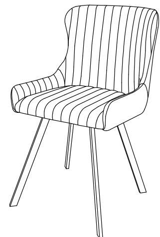
После сборки изделия допускается отклонение от плоскости 4 ножек до 1,5 мм, которое нивелируется в процессе эксплуатации
