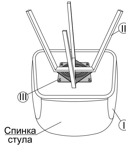
Для простоты сборки опоры рекомендуется крепежные винты затягивать только после установки всех элементов конструкции, включая сиденье
